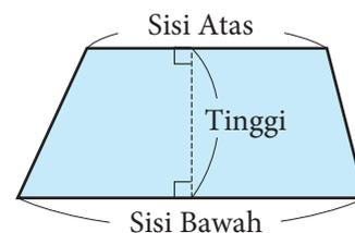
$$\text{Luas trapesium} = (\text{sisi bawah} + \text{sisi atas}) \times \text{tinggi} : 2$$
