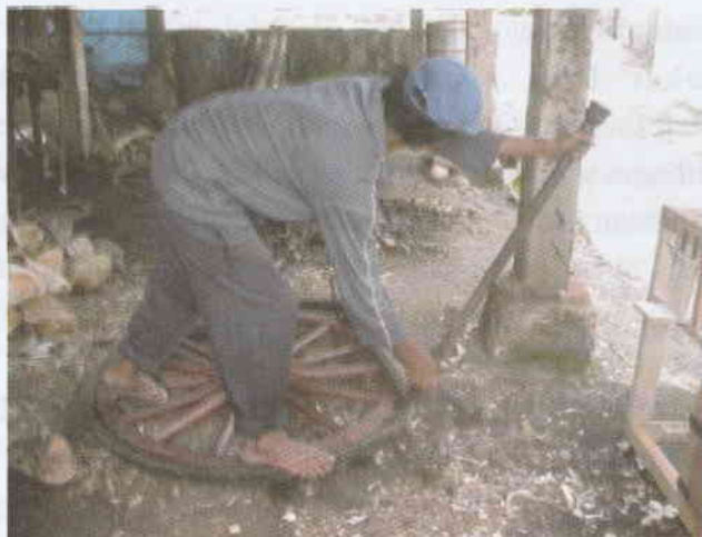
Foto : 99 Proses Pemasangan Karet Pada Roda Kayu
