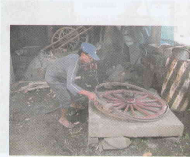
Foto : 97 Proses Pemasangan Pelapis Logam Roda kayu
