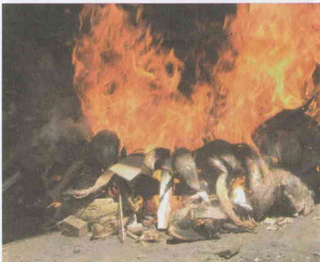
Foto : 96 Proses Pembakaran Plat Logam Pelapis Roda ditimbun Kayu Bakar
