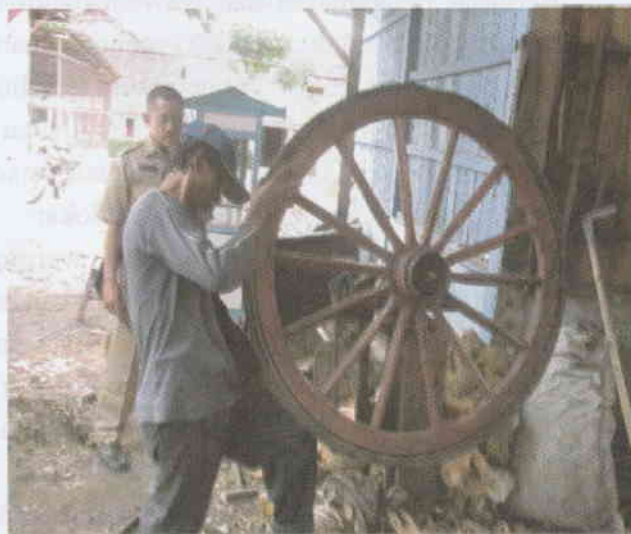
Foto : 100 Proses Pengecekan Perbaikan Roda Kayu
