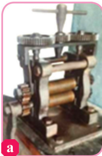
Gambar 1.23. Plat kerajinan logam; a. Alat penggiling logam menjadi plat, b. alat patri, c. tang lancip, d. penjepit.
