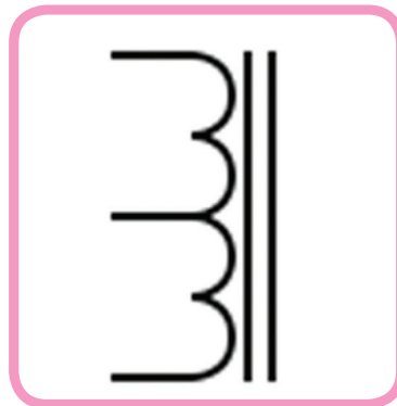
Sumber : Dokumen Kemdikbud Gambar 2.13 . Simbol autotransformator
